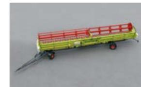
Remolque de transporte de 2 ejes con eje trasero articulado
