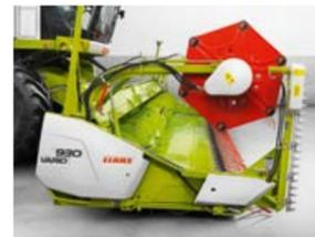
Mesa del mecanismo de corte sacada - con cuchillas de colza (+ 600 mm)
