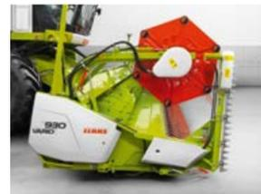
Mesa del mecanismo de corte metida - con cuchillas de colza (+ 450 mm)
