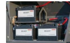
Dos baterías para la electrónica del motor 24 V, una batería para la electrónica de a bordo 12 V
