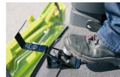
El bloqueo del diferencial permite un avance seguro, también en pendientes extremas. Seguridad adicional con el freno hidráulico de discos húmedos.
