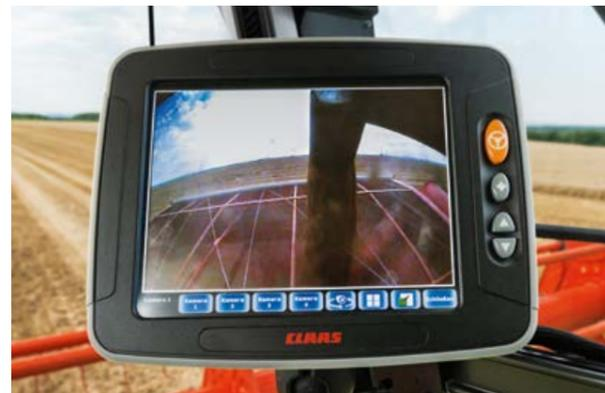
En total se pueden conectar hasta cuatro cámaras al sistema, pudiendo ser vistas simultáneamente en el monitor a color así como en el terminal S10 en la cabina.
