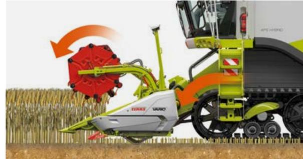
Mediante la comparación totalmente automática del estado real con el valor nominal, AUTO CONTOUR adapta óptimamente el mecanismo de corte a la forma del terreno – una importante facilitación del trabajo, sobre todo con grandes anchuras de trabajo, de noche, en cereal tendido, en laderas y en suelos con piedras. AUTO CONTOUR ayuda a incrementar el rendimiento y a hacer que el trabajo de LEXION sea aún más rentable.
