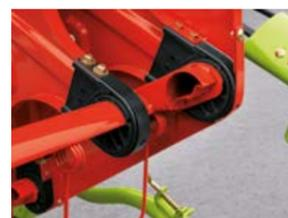
Soportes y cojinetes de las púas del molinete de plástico, con forma optimizada, para el menor transporte de tallos
